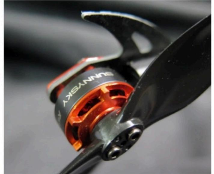
*Ein kleiner Brushless-Außenläufer treibt den Heckrotor direkt an*
